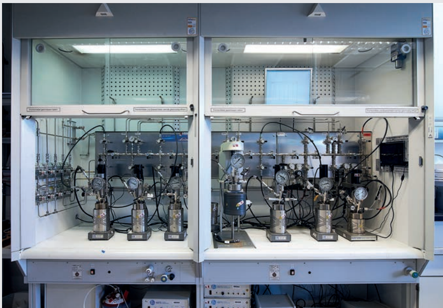
Apparatur: Parallelautoklaven zur Durchführung von Hochdruckcarbonylierungsreaktionen im Rahmen von Kataplasma. Foto: nordlicht/ LIKAT
