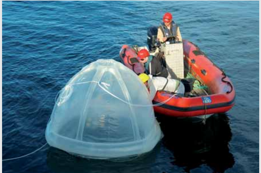
Der Mikrobiologe Christian Stolle nimmt vom Schlauchboot Proben aus einem schwimmenden „Mesocosmos“. Die futuristisch anmutende Kunststoffkuppel fängt Spurengase ein, die von Cyanobakterien zum Beispiel dann abgegeben werden, wenn sie zu viel Sonnenlicht abbekommen. Foto: vdL / IOW
