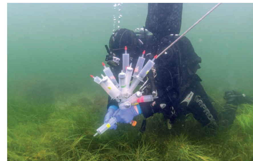
Entnahme von Wasserproben in einer Seegraswiese. Foto: E. Stohr, IOW
