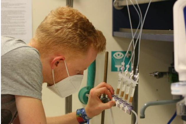
Abbildung 2: Angesäuertes, filtriertes Seewasser läuft über Extraktionssäulen zur späteren Analyse von DOM (Foto: H. Frazao).
