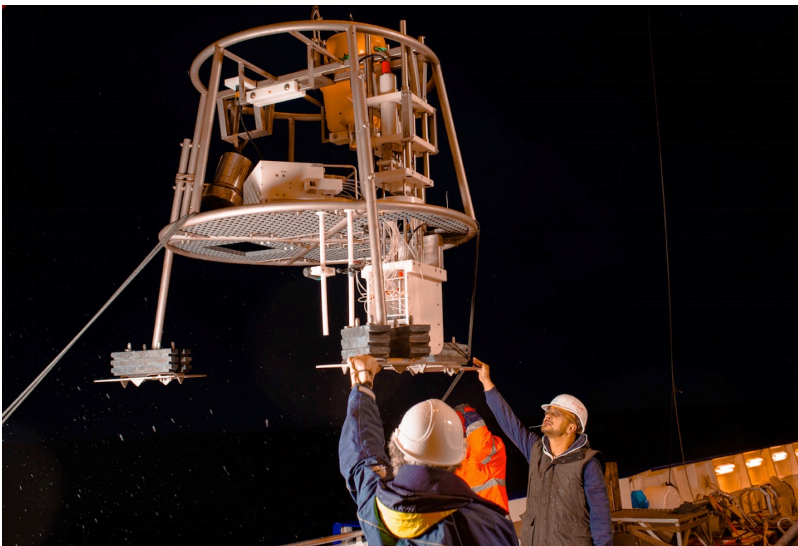
Abb. 2 WaBOB – „Warnemünder in situ Benthic Observation Chamber“ - mit der neu entwickelten Inkubationskammer, die sich sogar in sandigen Untergrund ein-senken kann.
