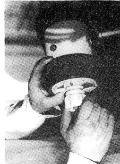
Abb. 3. Unteres Ende eines Behälterrohres, Handhabung des Ventils, Gummistopfen als Schutz gegen Einbeulen
